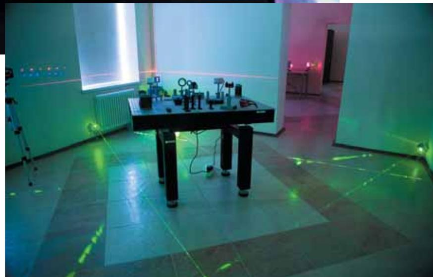
Макет охранной системы: лазерная паутина, соединенная со звуковой сигнализацией
