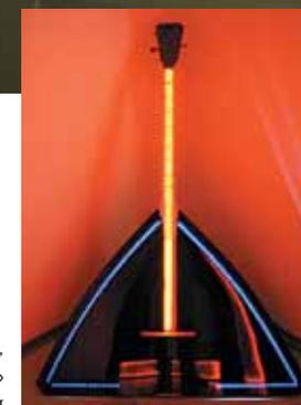
Стробоскопическая балалайка, позволяющая «увидеть» колебания струн
