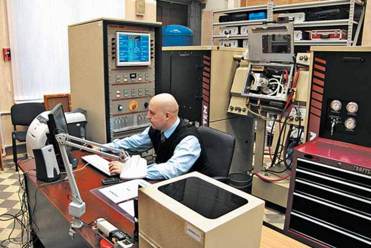
Научно-исследовательский центр «Материалы и технологии» оснащен уникальным комплексом Gleeble-3800 для испытания физических свойств металлов
