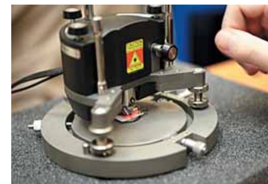
Мал золотник... Атомно-силовой микроскоп для исследования наноструктур, применяемых в электроэнергетике
