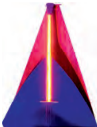
Стробоскопическая балалайка, позволяющая увидеть колебания струн.
