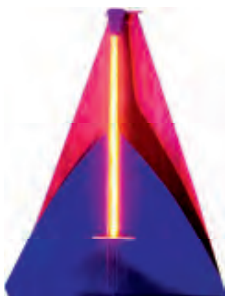
Стробоскопическая балалайка, позволяющая увидеть колебания струн.
